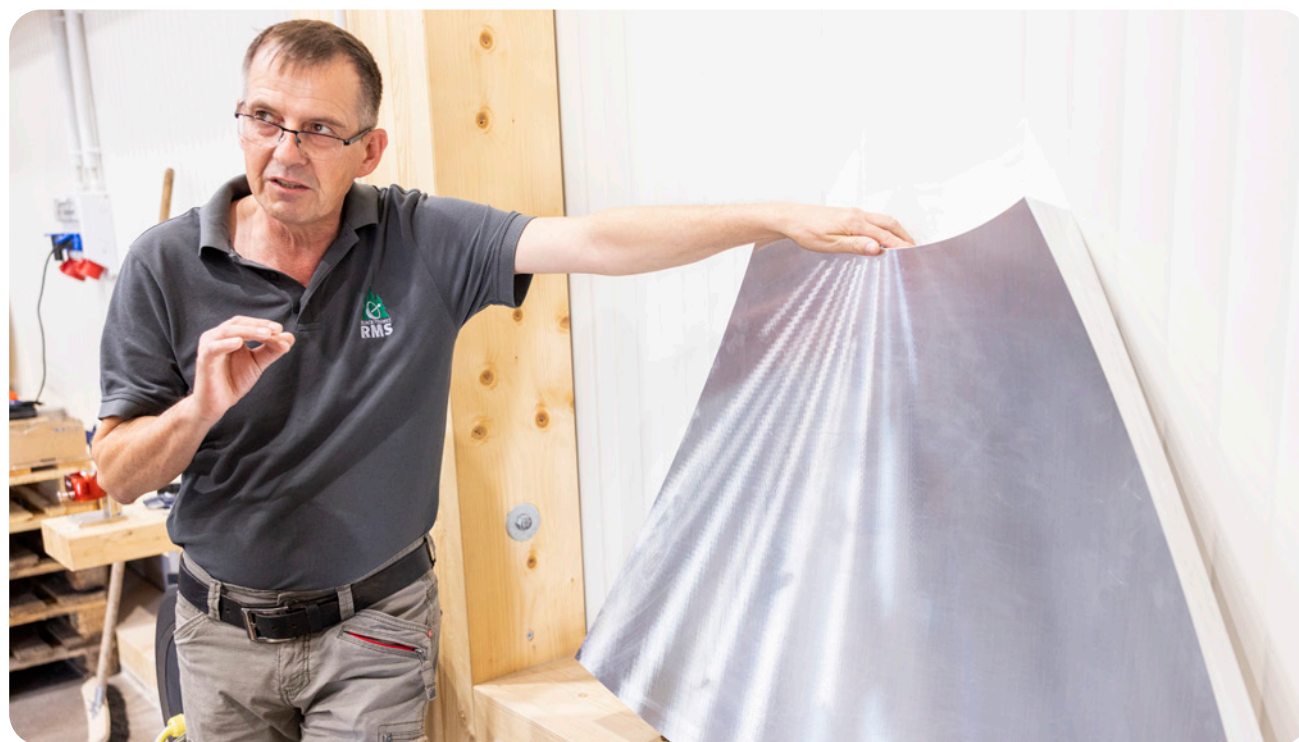
Nel caso dei componenti lucidi, il comportamento di regolazione della macchina risulta visibile sulla superficie del pezzo.
